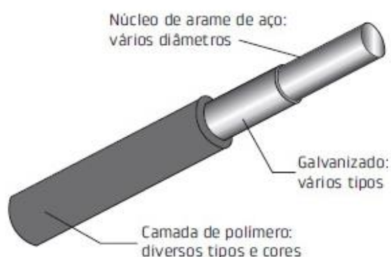
Figura 10 - Composição do arame usado em produtos de dupla torção
