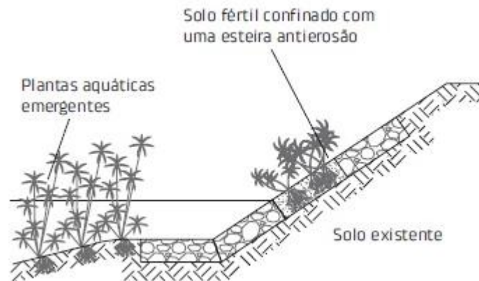
Figura 12 - Seção transversal de uma estrutura de gabião tipo colchão vegetado.
