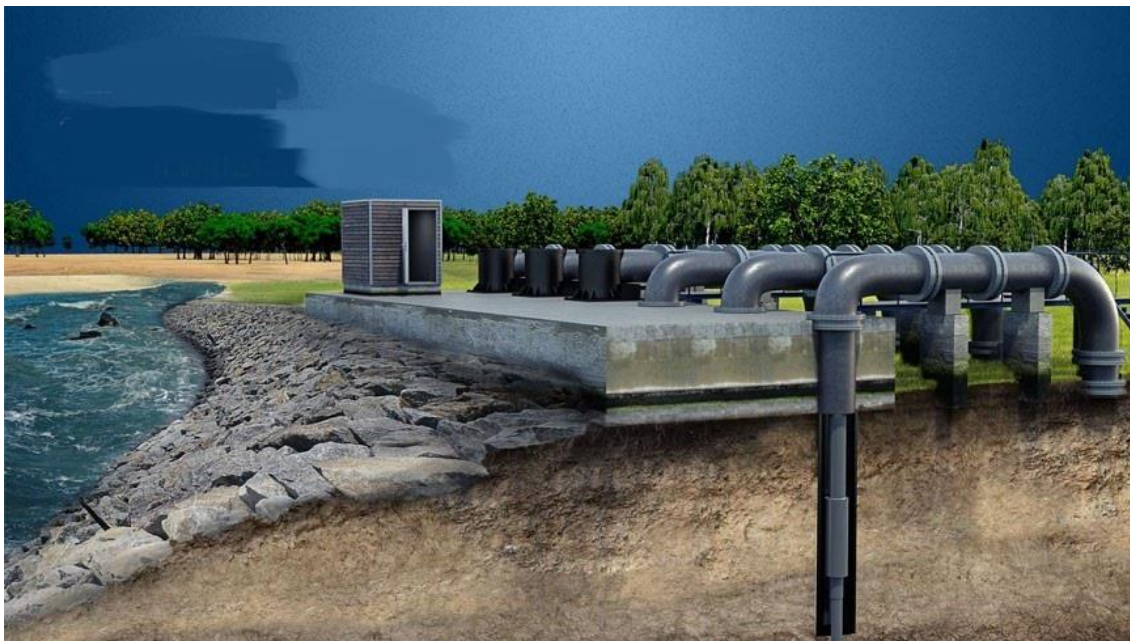
Figura 12 - Captação de água do mar.
