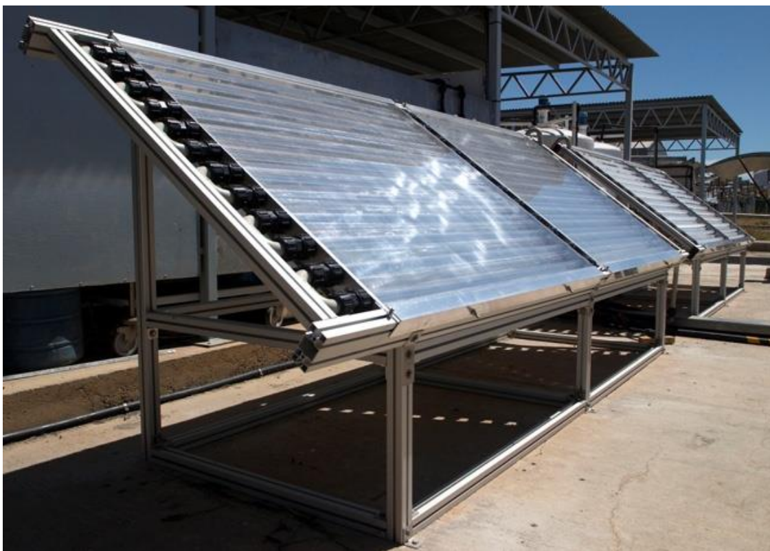
Figura 18 - Plataforma de desinfecção solar.
