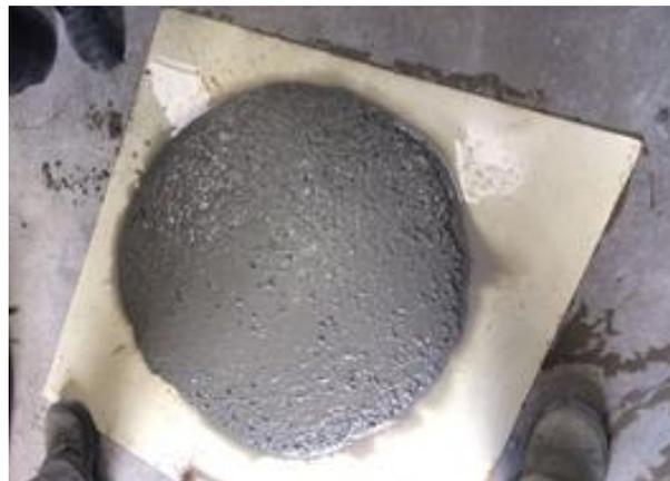
Figura 12 - Moldagem dos CP's
