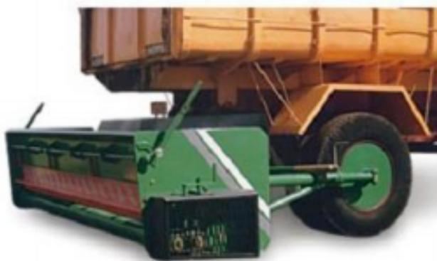
Figura 30 – Distribuidor de Agregado (Fonte: DOC, 2015)
