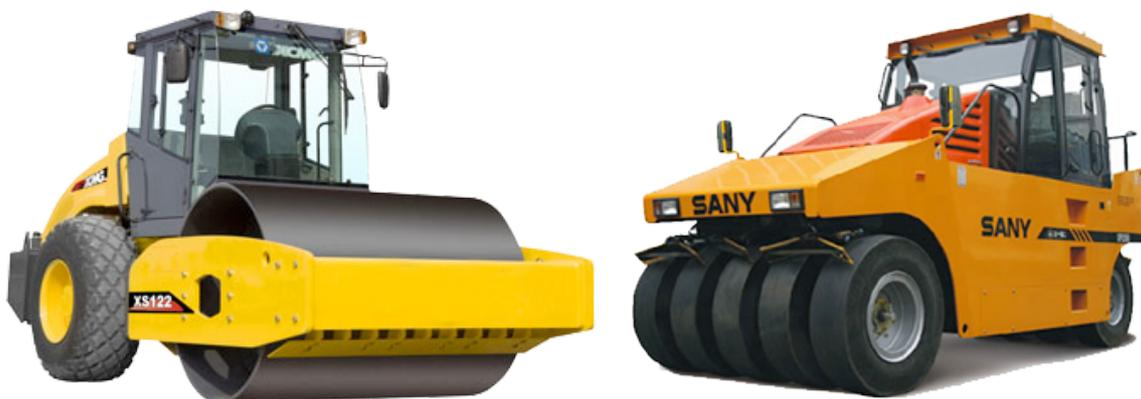
Figura 32 – Rolos compactadores liso e de pneus.
