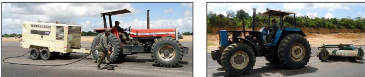
Figura 34 – Compressor de ar e vassoura mecânica respectivamente.
