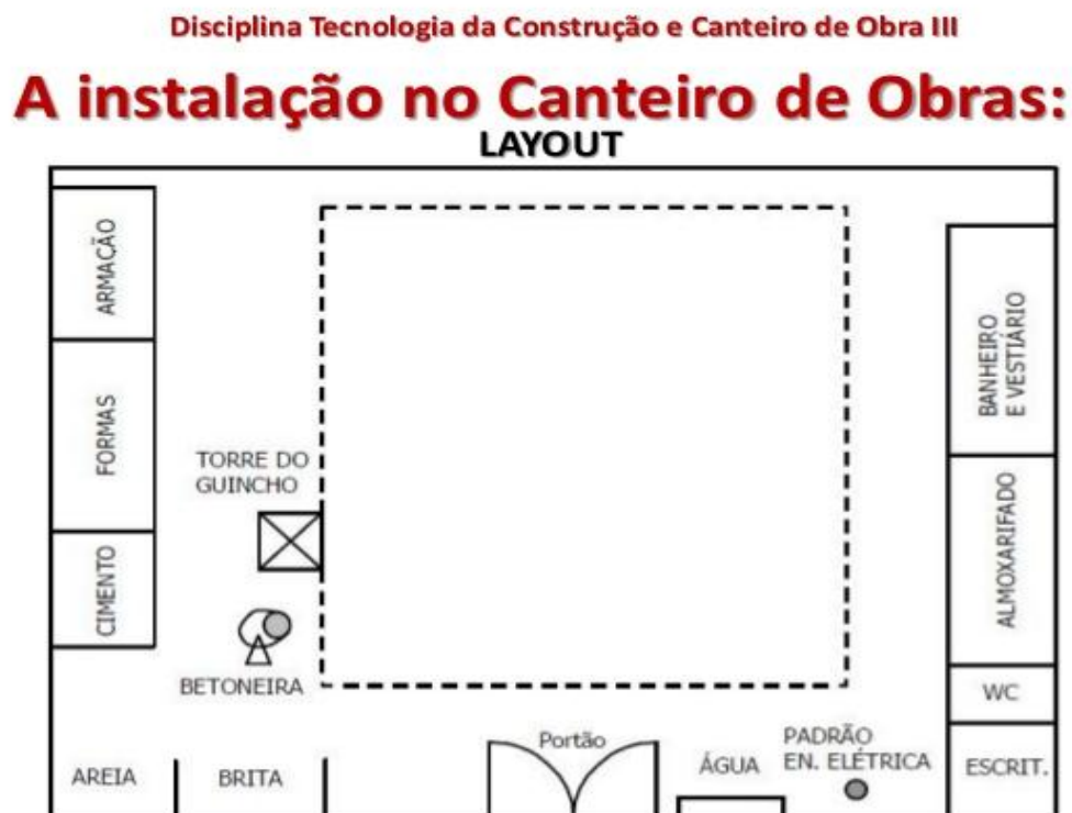
Figura 6: Layout de Canteiro de Obra
