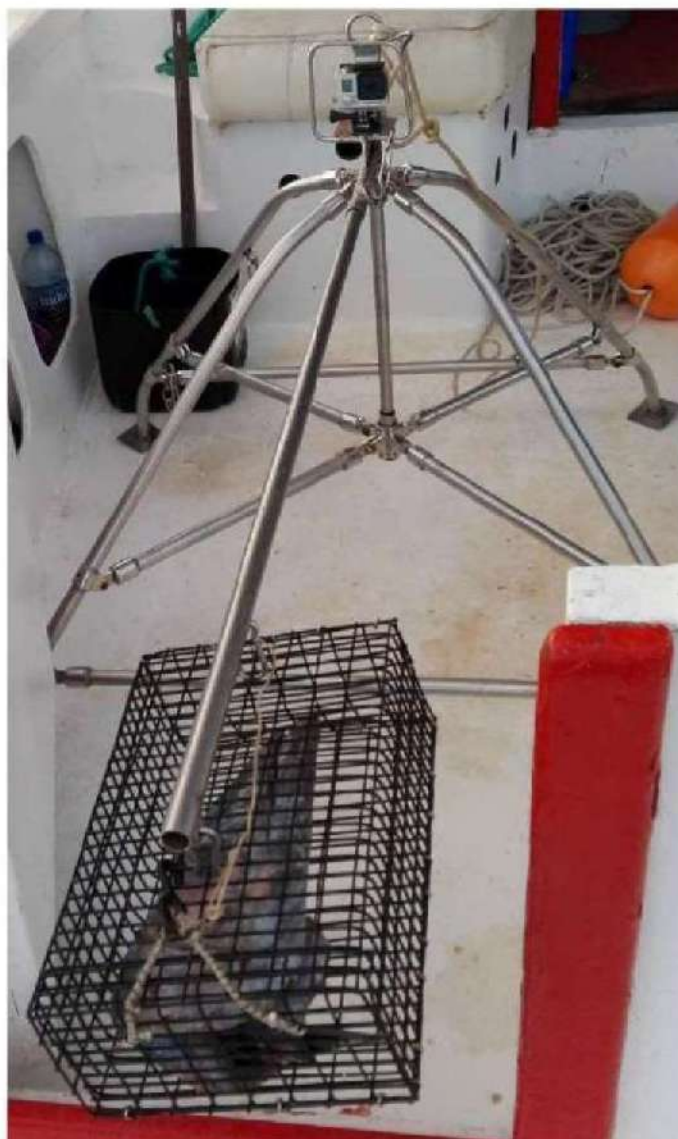
Figura 1. BRUVS utilizado no presente trabalho. Estrutura armada e pronta para lançamento, com câmera acoplada no ápice da pirâmide de metal e na ponta do braço guarnecida com iscas.
