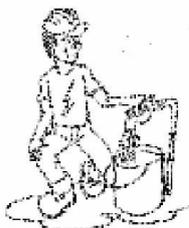
b) Adicionar lentamente a MASSA PARA ACABAMENTO GYPWAY polvilhando sobre a superfície da água
