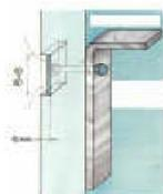
Fig. 7- Placa de metal com parafuso/porca e enchimento com GESSO COLA GYPWAY- Fixação transpassante metálica protegida de oxidação (galvanização ou pintura com 02 demãos de zarcão)
