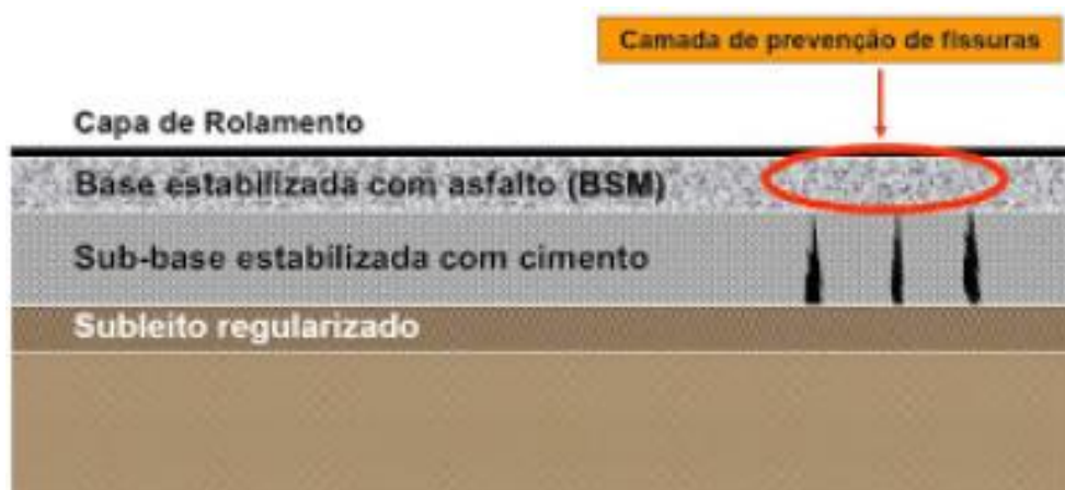
Figura 13 – Perfil do pavimento executado com camada BSM.
