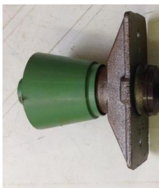
Figura 22 - Encaixe da forma para nicho com a placa de ancoragem
