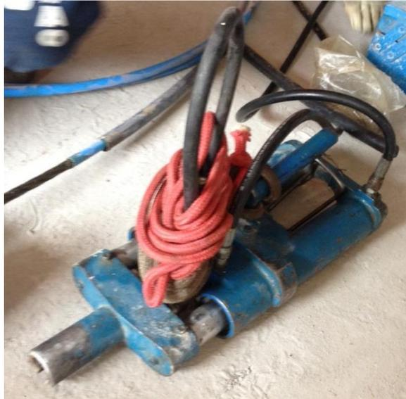
*Figura 25 - Macaco hidráulico com dois cilindros paralelos.*
