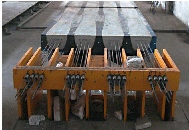
Figura 6 - Pré-tração em elementos pré-moldados [<http://civilengineersforum.com/prestressed-concrete-advantages-disadvantages/>]
