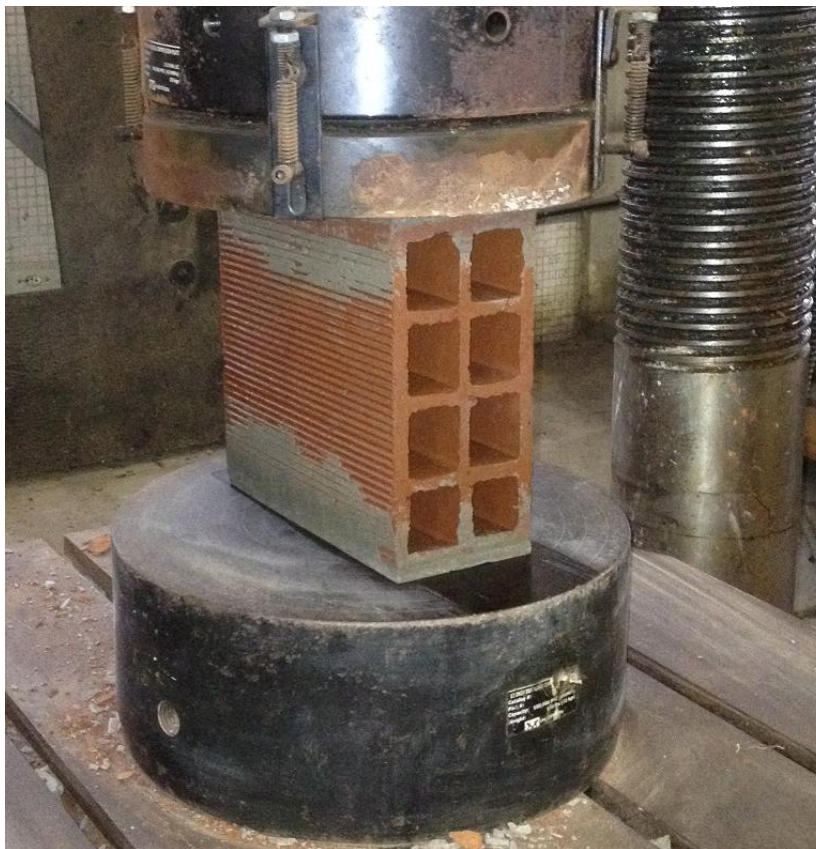
Figura 08 – Demonstração de uma ruptura de bloco em ensaio de resistência à compressão.
