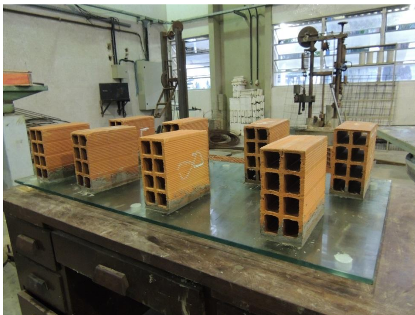
Figura 06 – Processo de capeamento dos blocos.
