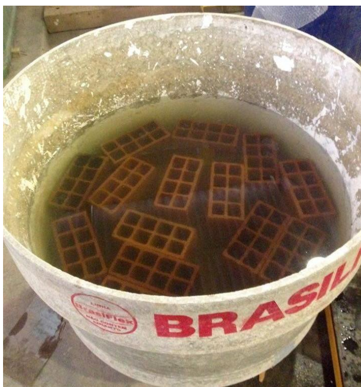
Figura 05 - Uma série de blocos submersos em água.
