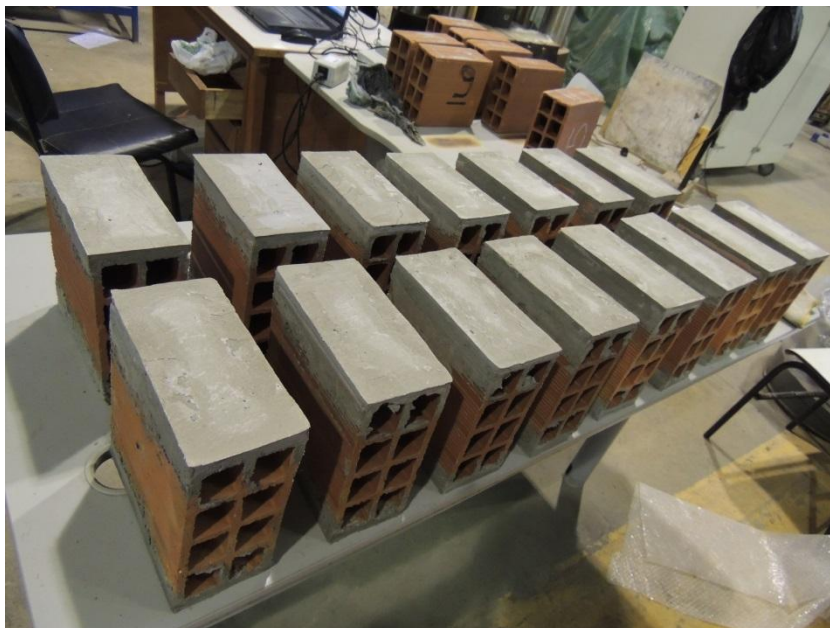
Figura 07 – Blocos com capeamento das devidas faces de trabalho.
