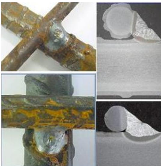
Figura 16. ( Solda não estrutural, ou de posicionamento/Imagem retirada da Apresentação ArcelorMittal-Aço Pronto NE – Pré-armados).
