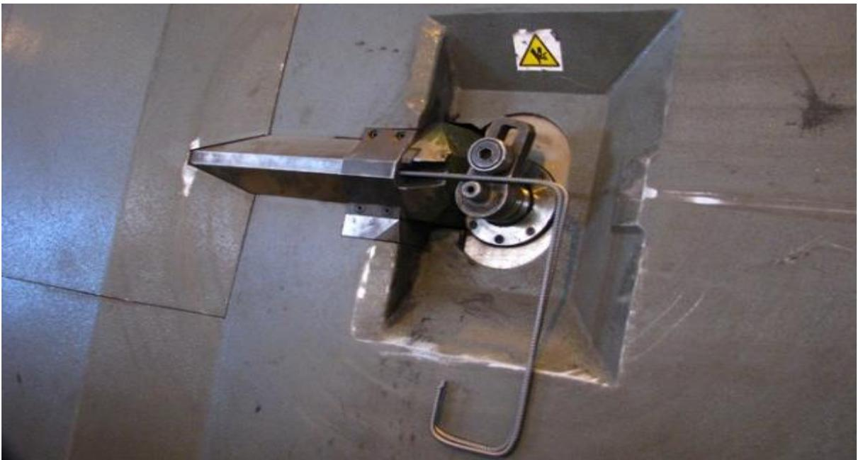
Figura 8. (Máquina automática de dobra dos vergalhões/ Foto tirada na Aço Pronto Nordeste, Recife, 2015).
