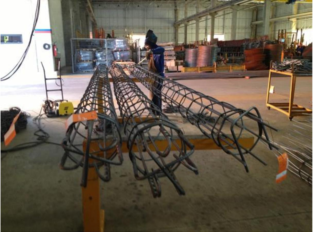
Figura 12. (Estacas recebendo tratamento final, devidamente identificadas/ Foto tirada na Aço Pronto Nordeste, Recife, 2015).
