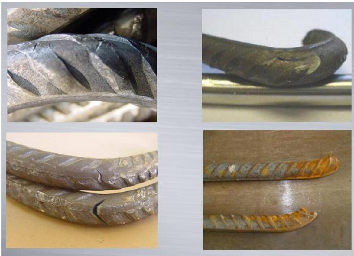
Figura 3. (Rompimentos indesejáveis do aço na dobra/ Fotos cedidas pela Aço Pronto NE).
