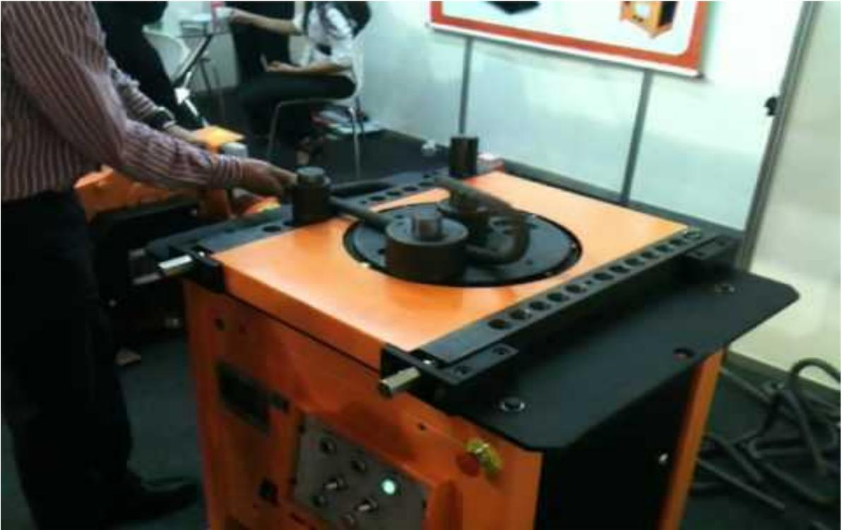
Figura 9. (Maquina semiautomática de dobra dos vergalhões/ Imagem retirada da internet).
