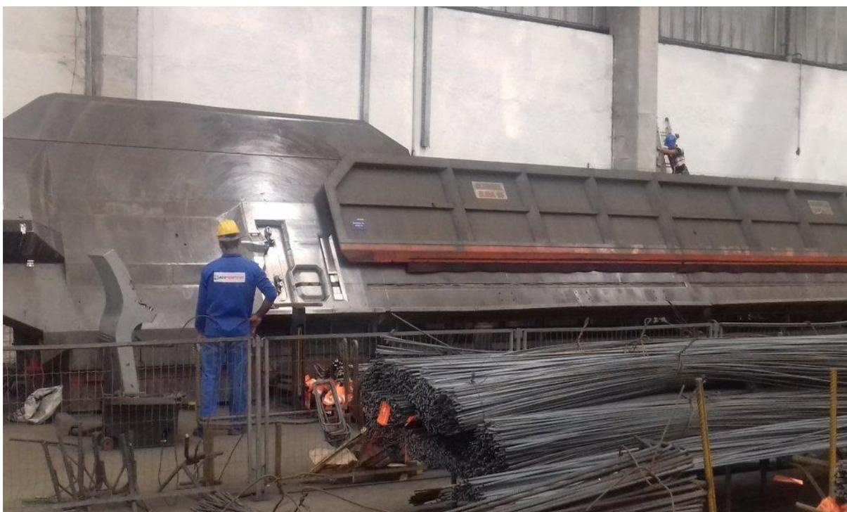
Figura 6. (Máquina de endireitamento do aço em bobina/ Foto tirada na Aço Pronto Nordeste, em Recife. 2015 ).
