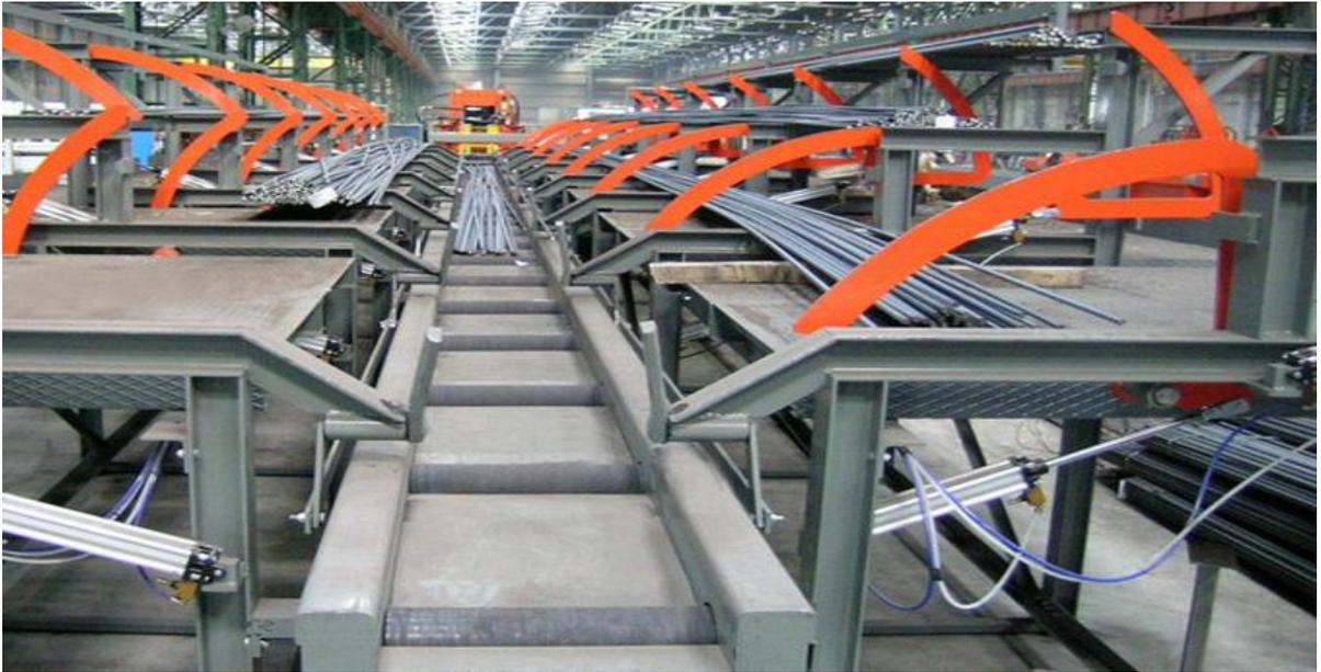
Figura 7. (Máquina de corte dos vergalhões/ Imagem de uma Indústria de Corte e Dobra alemã).
