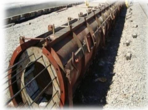
*Foto 3.11. Estaca após a pré-tensão seqüencial.*
