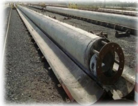
*Foto 3.14. Estaca após atingir resistência de 30Mpa.*
