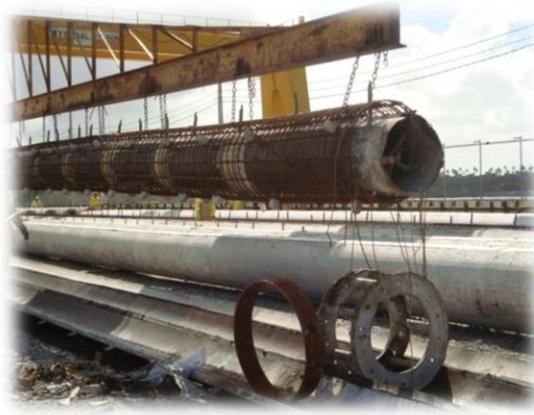
*Foto 3.9. Transporte da ferragem através da ponte rolante.*
