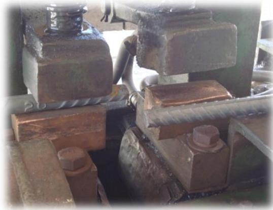
*Foto 3.2. Ajuste das barras de aço para o alinhamento.*
