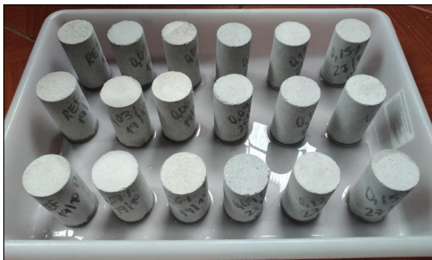
Figura 34 – Realização do ensaio de absorção de água por capilaridade.
