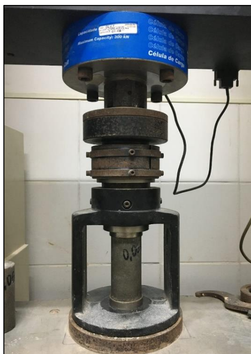
Figura 33 – Realização do ensaio de resistência à compressão axial.
