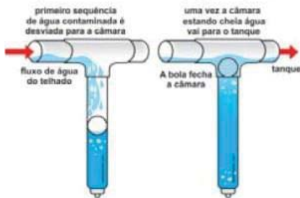
Figura 1 - Esquema básico de dispositivo de descarte das primeiras chuvas.
