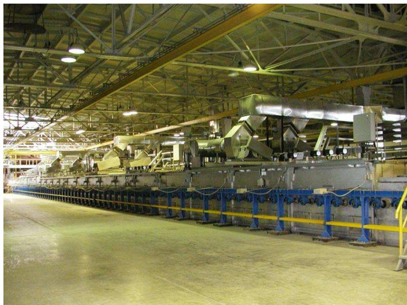
Figura 2-16 – Foto estenderia para alívio de tensões do vidro.
