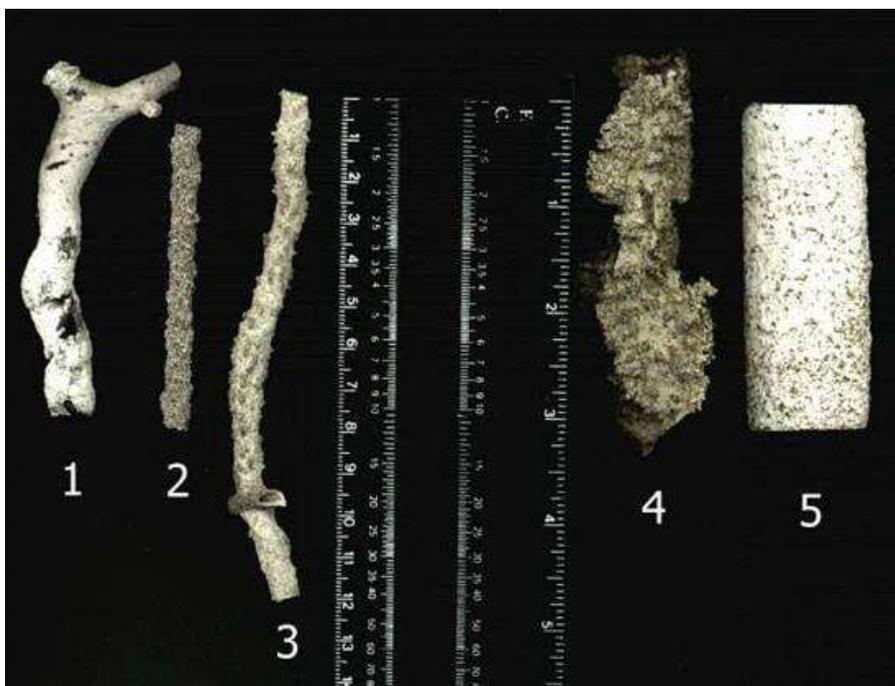
Figura 2-1 – Vidros gerados pela natureza.
