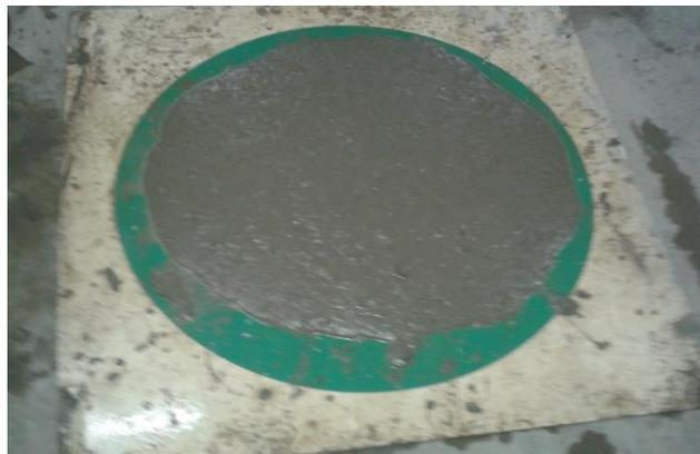
Figura 12 – Ensaio de espalhamento
