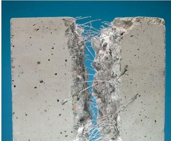
**Fig. 2.8** – Fibras de aço no concreto (fonte: [www.concremix.com.br](http://www.concremix.com.br)).
