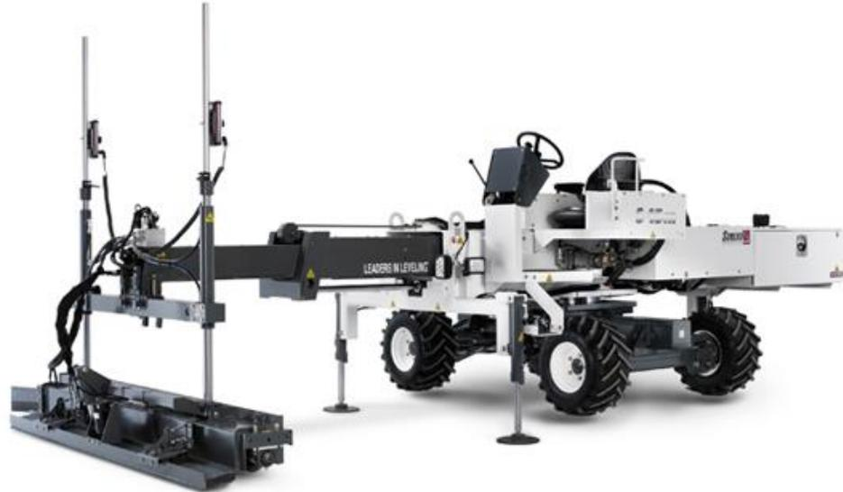
**Fig. 2.7** – Screed Laser (fonte: [www.betomaq.com.br](http://www.betomaq.com.br))
