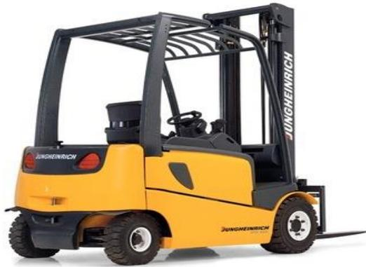
**Fig. 2.10** – Empilhadeira de rodagem simples (fonte: jfcempilhadeiras.com.br).
