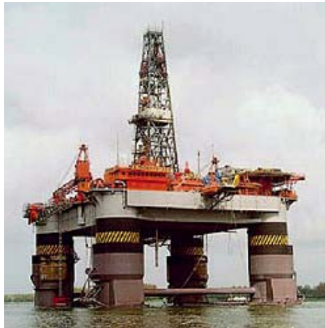
Figura 5 – Estação semi-submersível de Exploração de Petróleo Offshore
