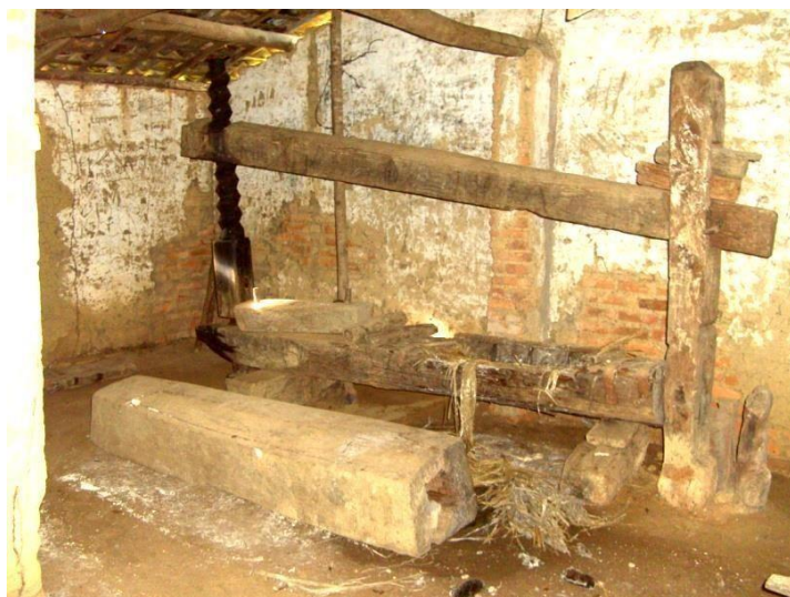
Figura 36 - Prensa para tirar a manipueira da mandioca e o fuso da prensa
