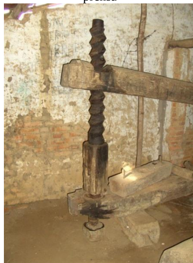
Figura 37 - Prensa para tirar a manipueira da mandioca e o fuso da prensa
