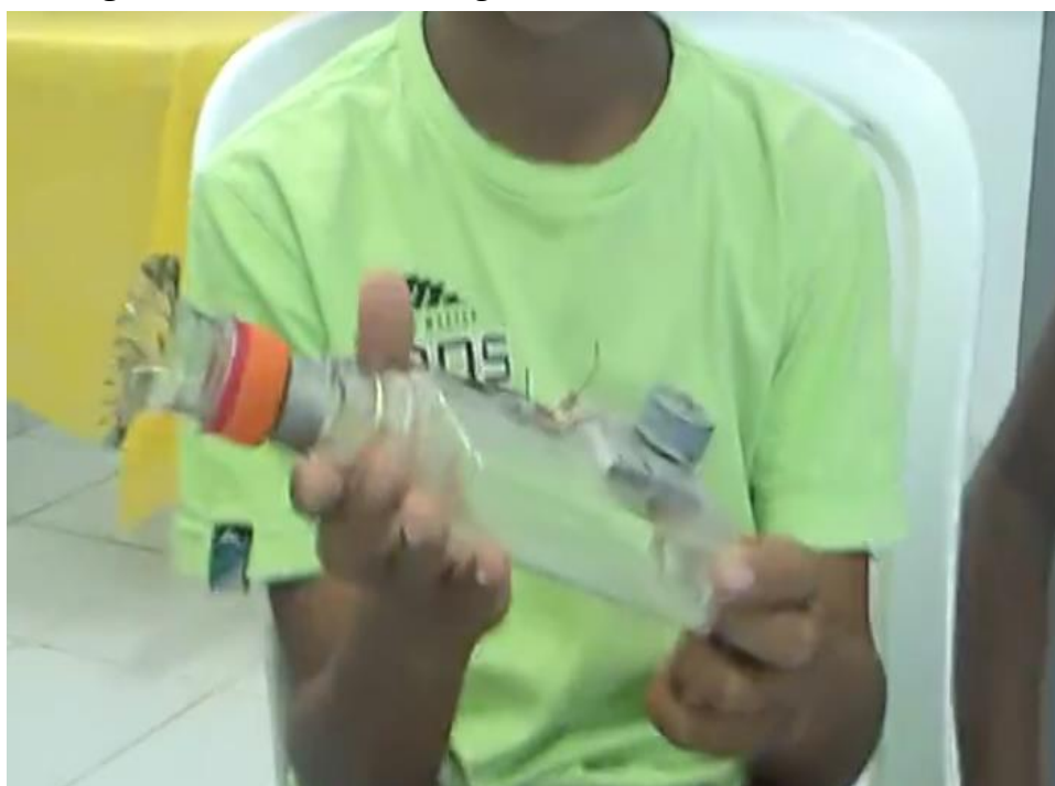
Figura 26: Barco feito com garrafa PET, motor de DVD e bateria
