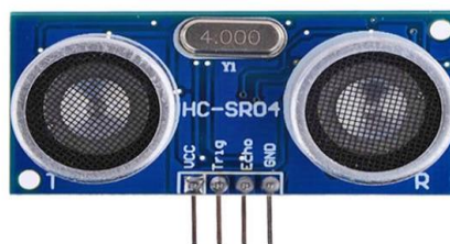
Figura 9: Sensor HC-sr04 (Ultrassônico) - exemplo de sensor extroceptivo
