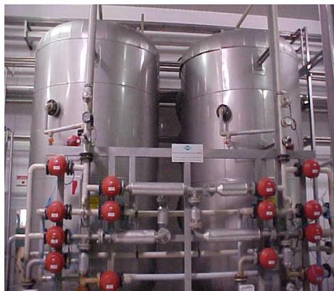
**Figura 33: Coluna de troca iônica**
