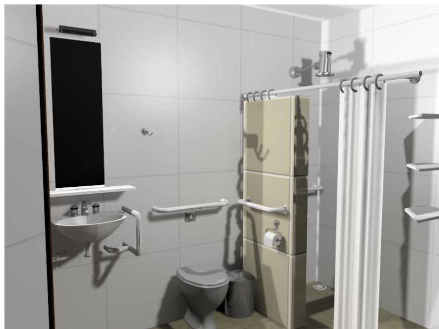
Figura 24: Vista 3D Barras de Apoio
