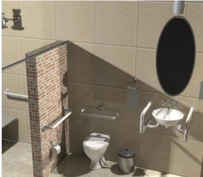
Figura 27: Vista 3D Barras de Apoio
