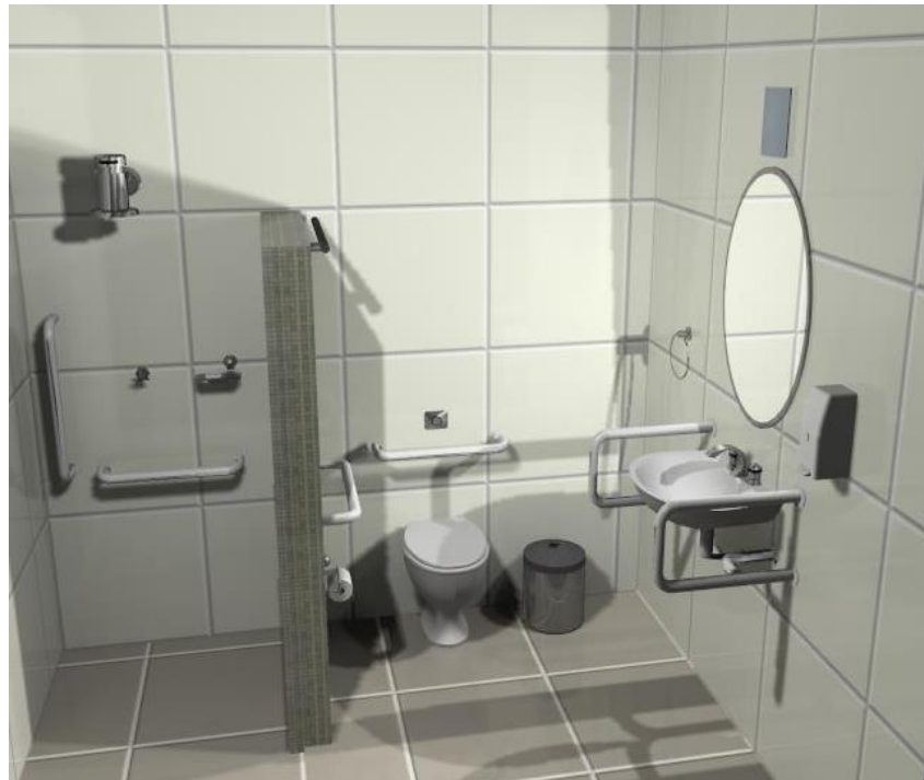
Figura 30: Vista 3D Barras de Apoio
