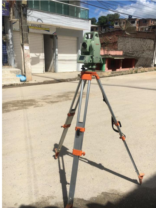
Figura 21: Estação Total no Campo
