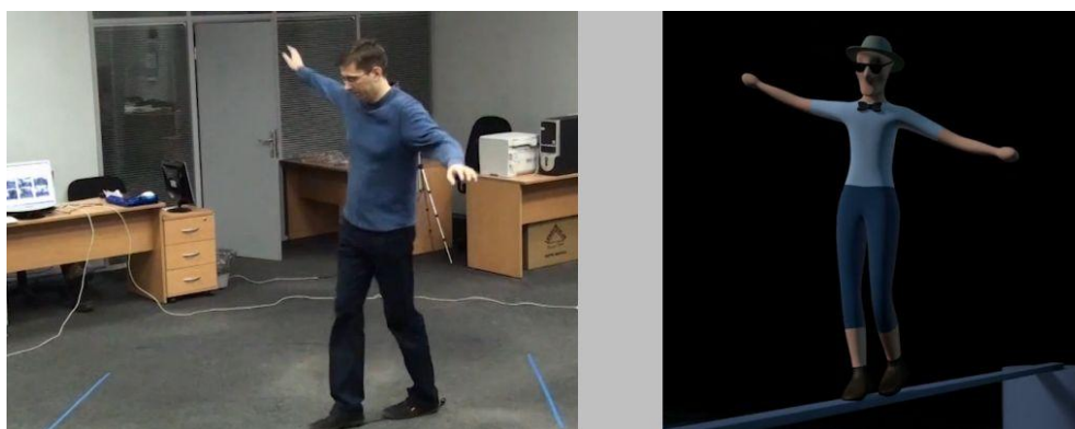
Figura 47: Comparação do vídeo gravado no aplicativo IPi Recorder ® com o resultado do cálculo da captura de movimento no IPi Mocap Studio ® .
