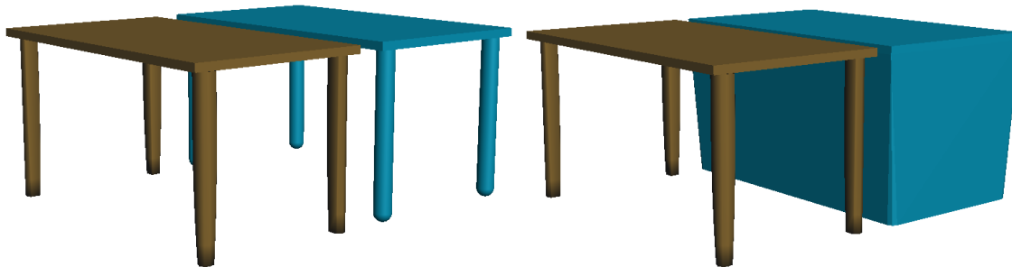
Figura 35: A grade da mesa na figura a esquerda (a) está melhor encaixada a forma geométrica do objeto, ao contrário da figura esquerda (b).
