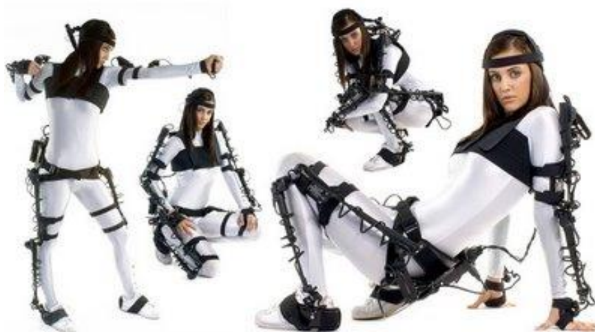
Figura 14: Modelo com roupa para captura do movimento a partir do sistema mecânico.
