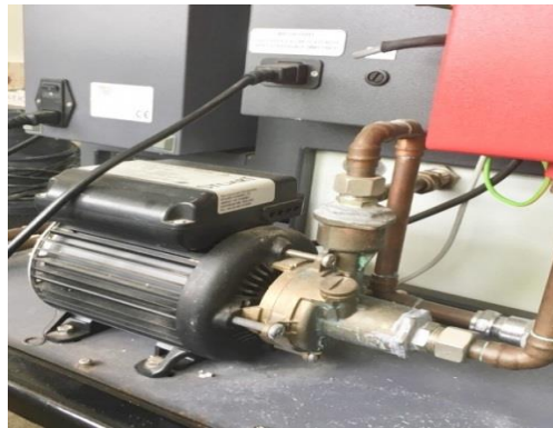
Figura 18 - Bomba recirculação de fluído.
