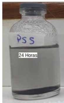
Figura 11 - Decantação de nanopartículas de Grafeno após 24h.
