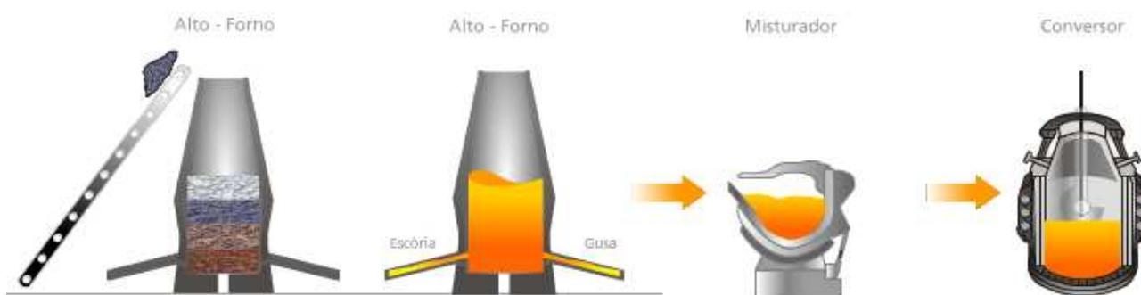
Figura 1.3: Processo de fabricação – usinas integradas.
