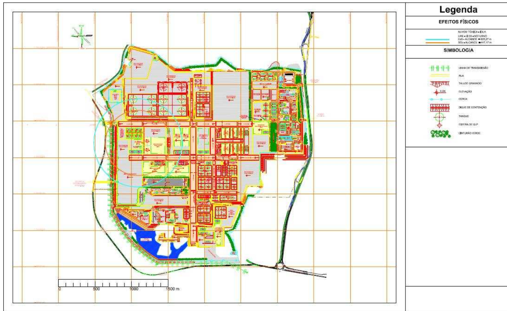
Figura 4.11 - Alcance da nuvem tóxica no período noturno do EI-03 para a concentração IDLH, em todas as direções do vento e com a velocidade média do vento igual a 3,6 m/s.
