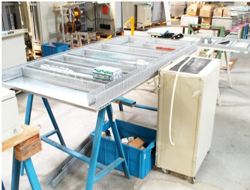
*Figura 7.3 – Posto de Trabalho (1): Chapas de Montagem para Painéis Elétricos*
