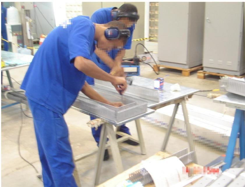
*Figura 7.4 – Posto de Trabalho (2): Chapas de Montagem para Painéis Elétricos*
