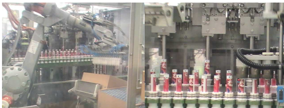
Figura 3.6 – Robô da enchedora C10(esq.) e massa sendo envasada na bisnaga.
