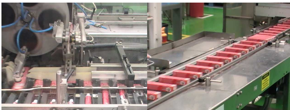
Figura 3.8 – Encartuchadeira (esq.) e esteira transportadora de cartucho (dir.)
