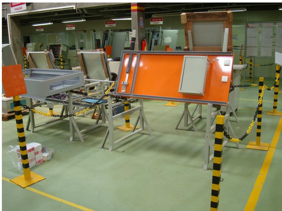
Figura 3. 7 - Processo de colocação de equipamento e passagem de cabos, setor de fiação de chapas (Fonte: Autor)
