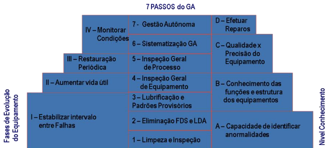
Figura 2.4 Relação passos da Manutenção Autônoma com o nível de conhecimento dos operadores e evolução do equipamento (ALCOAb, 2005).
