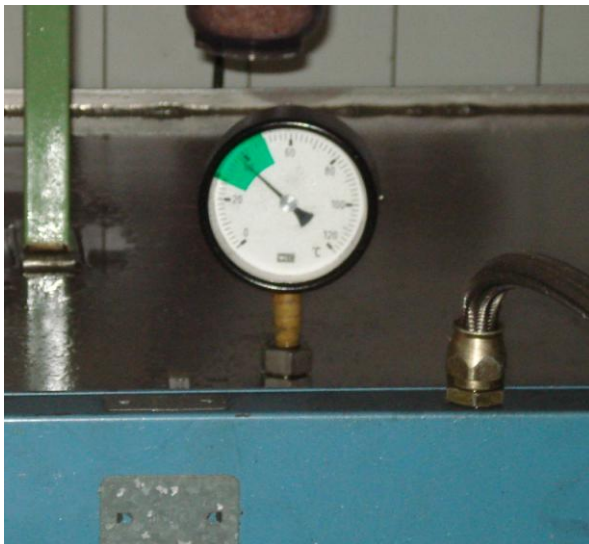
Figura 3.8 Identificação da faixa de trabalho de um manômetro (Fonte: Empresa estudo de Caso).
