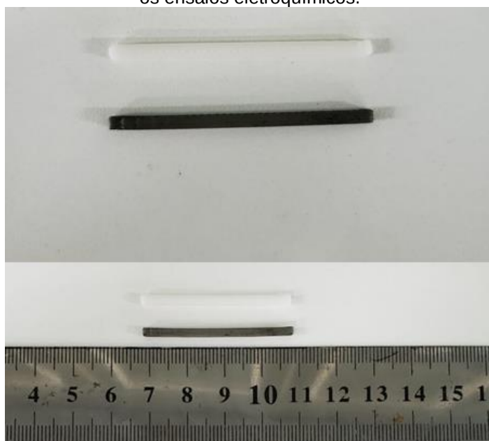
Figura 33 - Peça de ABS recoberta com Polipirrol (PPI) utilizada como prova de conceito para os ensaios eletroquímicos.
