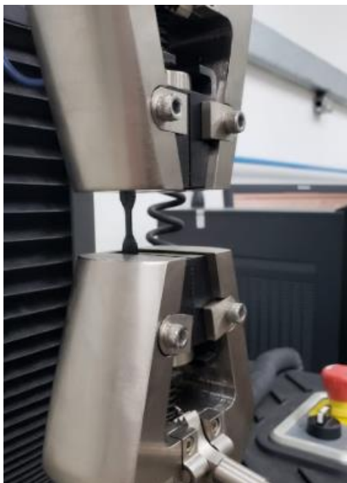
Figura 32 - Ensaio de tração de um dos corpos de prova ABS/PPi ( FeCl_3 ).
