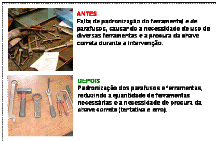
Figura 4.2 – Padronização do ferramental e dos elementos de fixação
