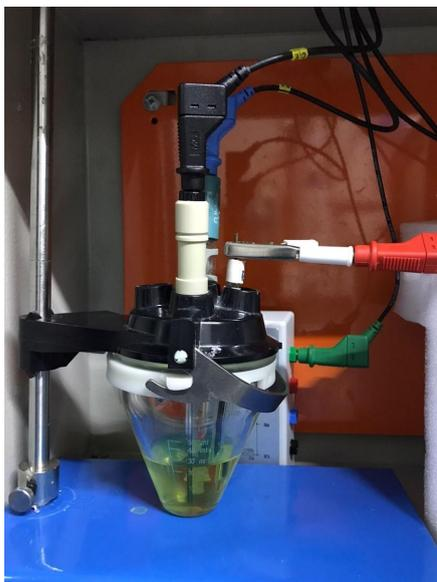
**Figura 14.** Célula eletroquímica contendo três eletrodos em uma solução de ferro-ferricianeto de potássio. Fonte: próprio autor.
