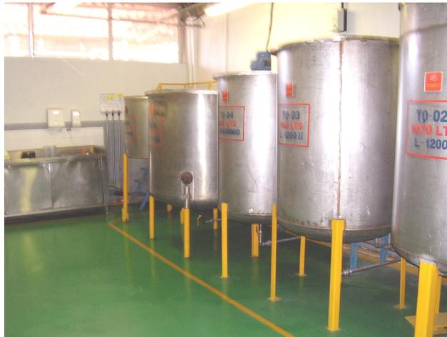
**Figura 3.4. Tanques de mistura de beta caroteno**
