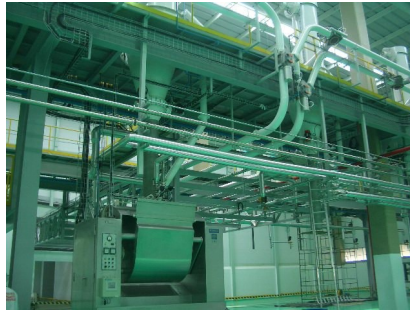
Figura 3.4 - Sistema de mistura de massas Fonte: Empresa estudada (2007)
