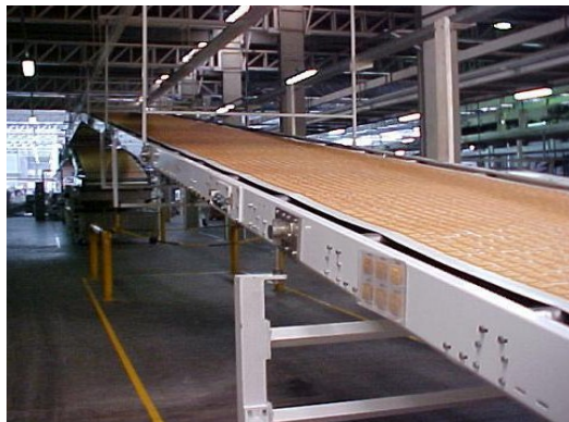
Figura 3.7 - Lona de resfriamento Fonte: Empresa estudada (2007)
