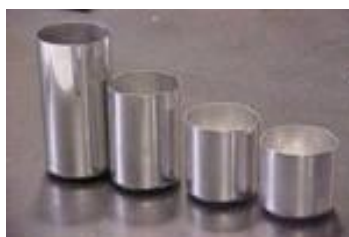
Figura 4.5 - Transformações no estiramento da lata
