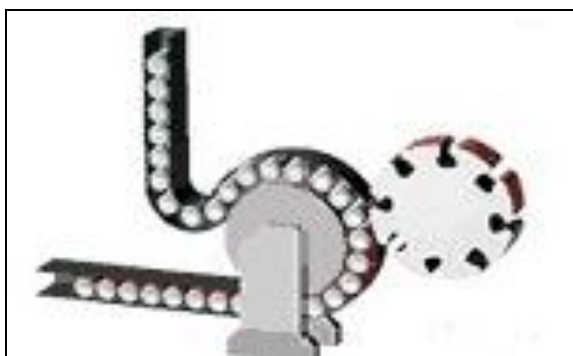
Figura 4.7 - Sincronismo da Printer na pintura da lata
