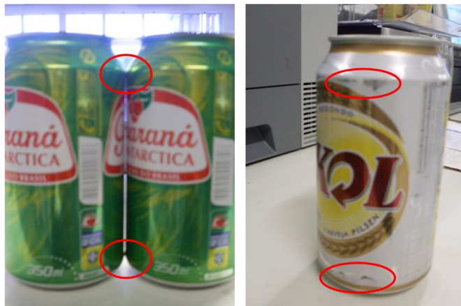
Figura 4.14 - Pontos de contato e abrasão
