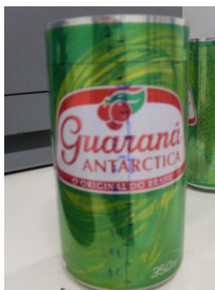
Figura 4.8 - Lata após cura do verniz
