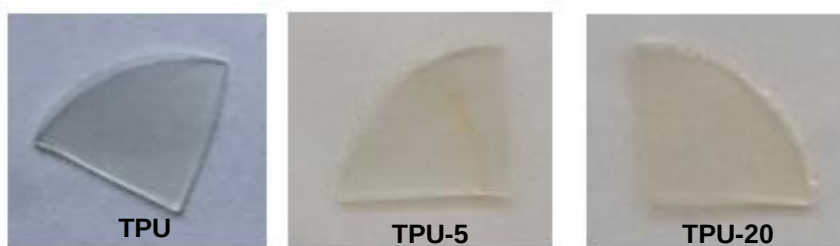
Figura 19 - Amostras de TPU não irradiado e irradiado a 5 e 20 kGy.
