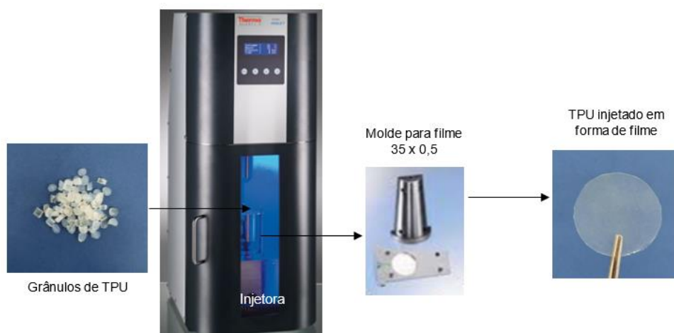
Figura 17 - Representação esquemática do processamento de moldagem por injeção do TPU.
