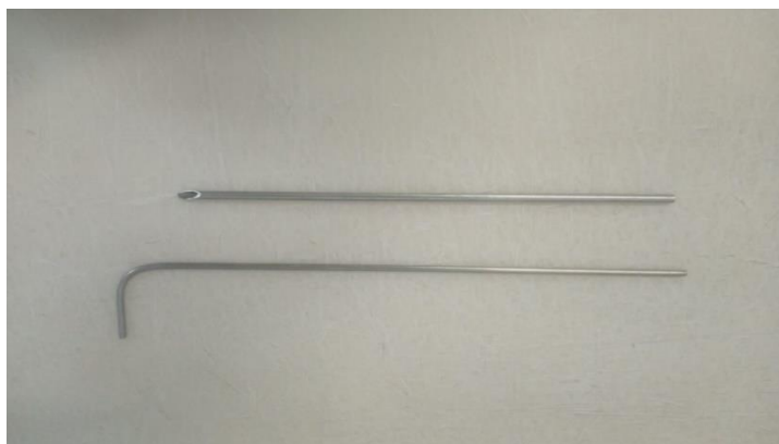
Figura 14 - Sashibo, instrumento cortante para puncionar o dorso do atum
