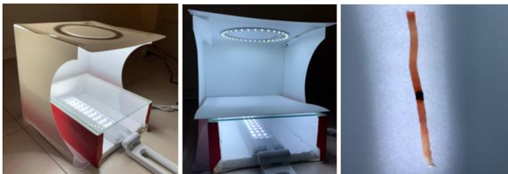
Figura 25 - Configuração alternativa de iluminação por trás das amostras de atum
