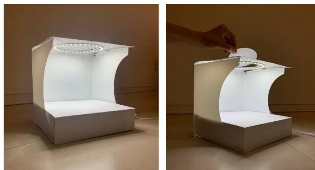
Figura 22 - Configuração adotada do SVC para captura de imagens de amostras de atum e salmão, constando de estúdio fotográfico com luzes de LED circulares e abertura no topo
