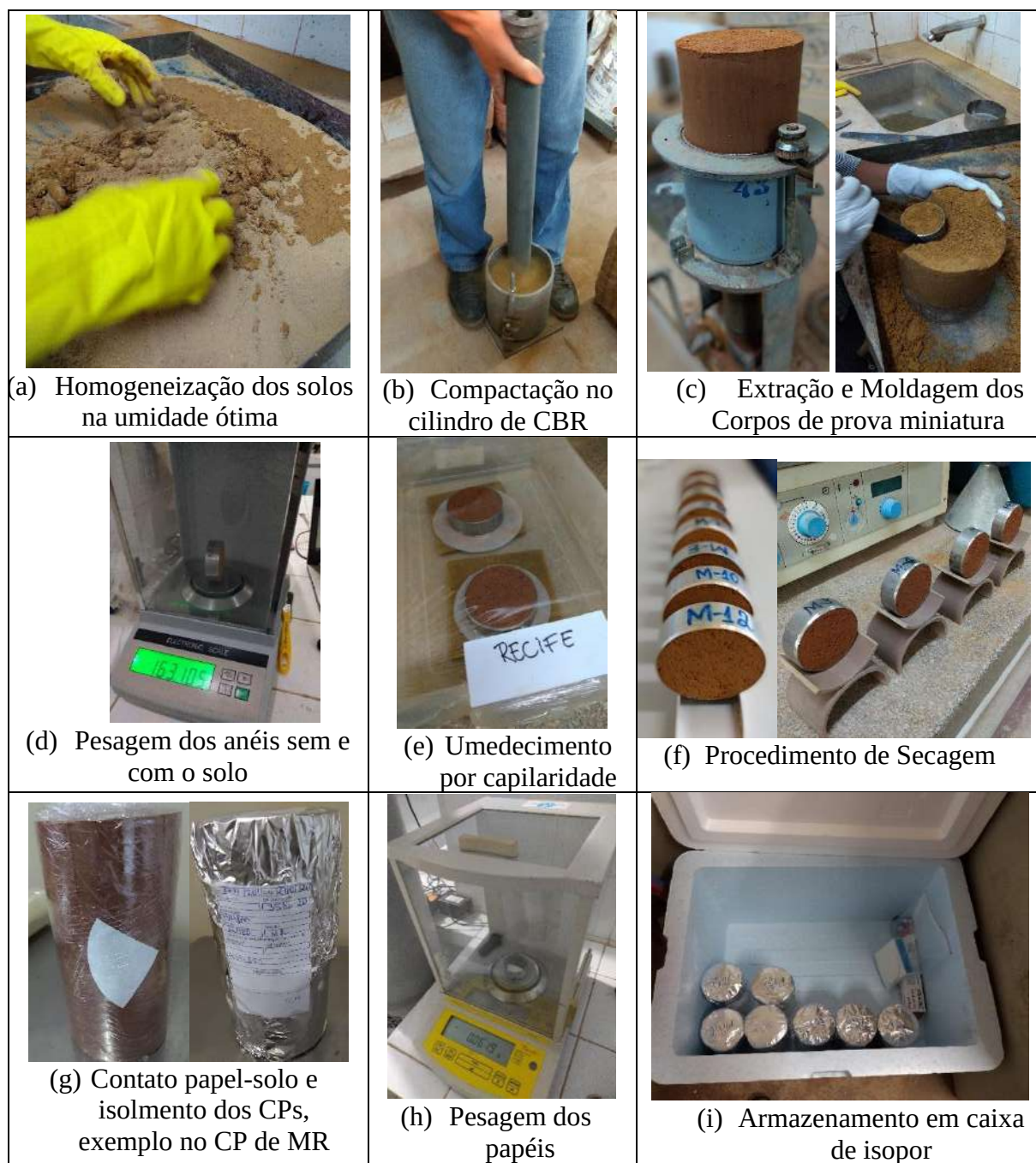
Figura 4.19 – (a)-(i) Ensaio da Curva Característica - Método do Papel Filtro, procedimentos adotados no LSI/UFPE, durante a realização dos ensaios desta pesquisa e na COPPE.
