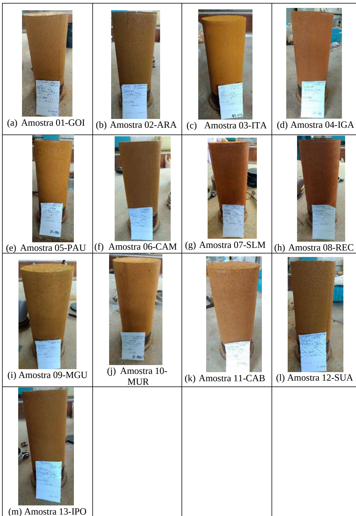
Figura 4.25 – (a)-(m) Aspectos dos corpos de prova preparados para ensaios de MR dos solos desta pesquisa.
