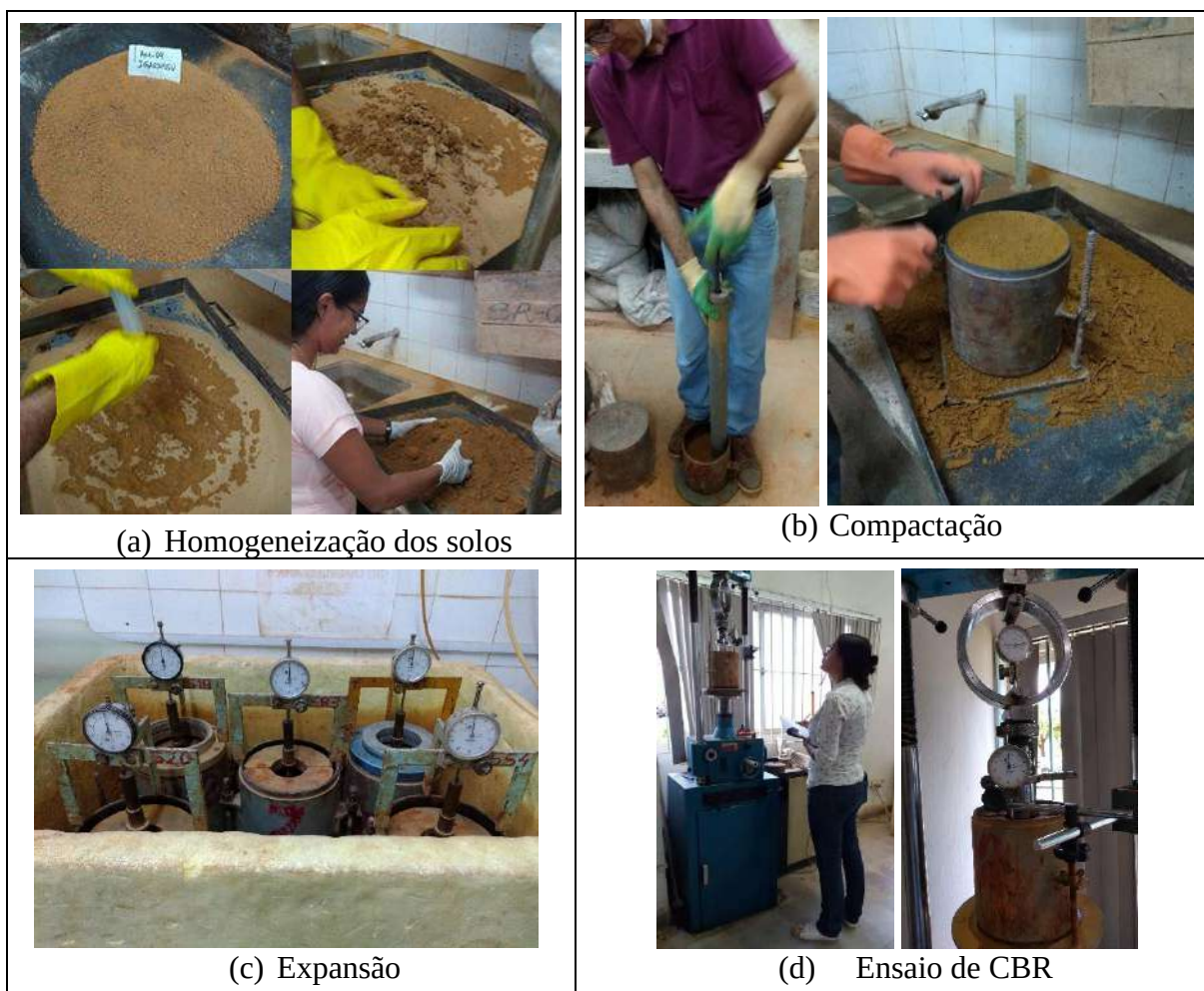
Figura 4.23 – (a)-(d) Passo-a-passo dos ensaios de Compactação, CBR e Expansão realizados no LSI/UFPE.
