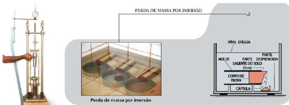
Figura 2.19 – Ensaio de Compactação Mini-MCV (à esquerda) e Perda de Massa por Imersão (à direita).
