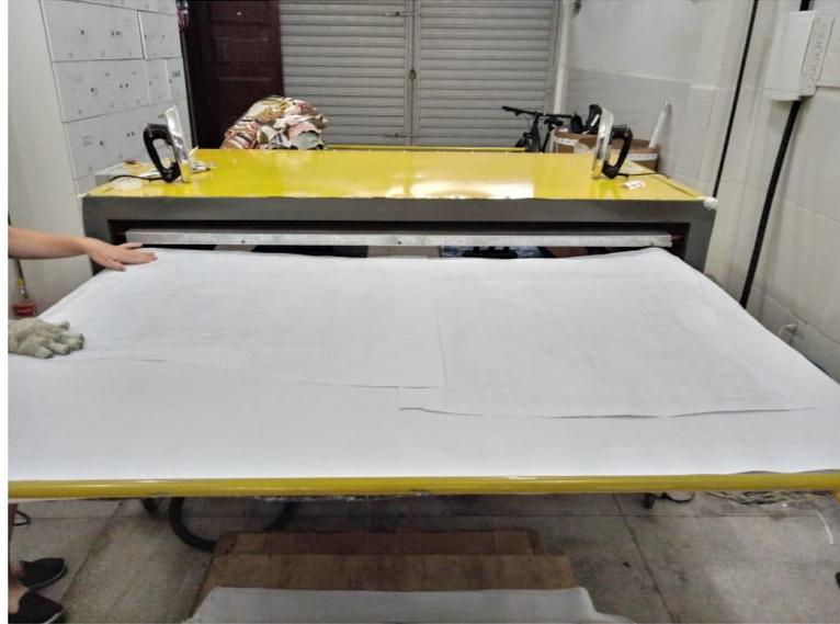
**Figura 37 – O papel sublimático é colocado sob a peça branca e levado para a prensa**
