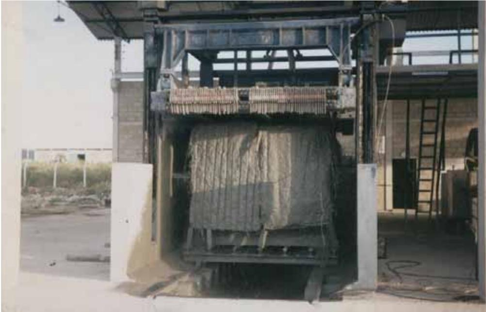
Figura 2 : Bloco posicionado para serragem no tear.
