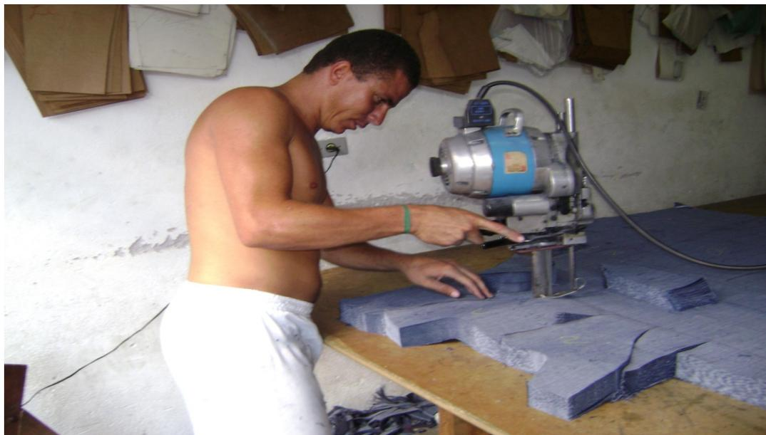
Figura 7(5): Cortador em atividade com tesoura elétrica
