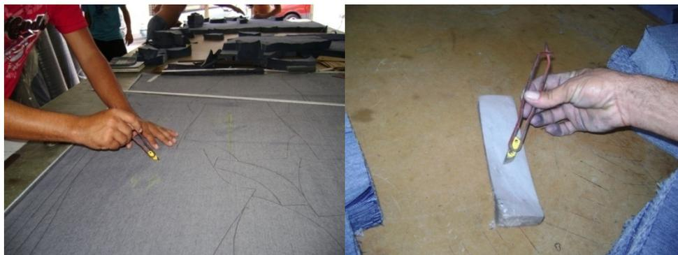
Figura 19(5): Faca serrilhada usada para o corte do couro e do jeans
