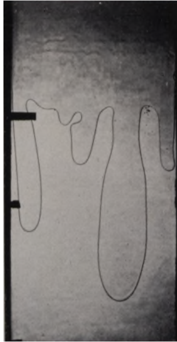
Figura 3 – Competição entre dedos viscosos para a célula de Hele-Shaw retangular disposta verticalmente.
