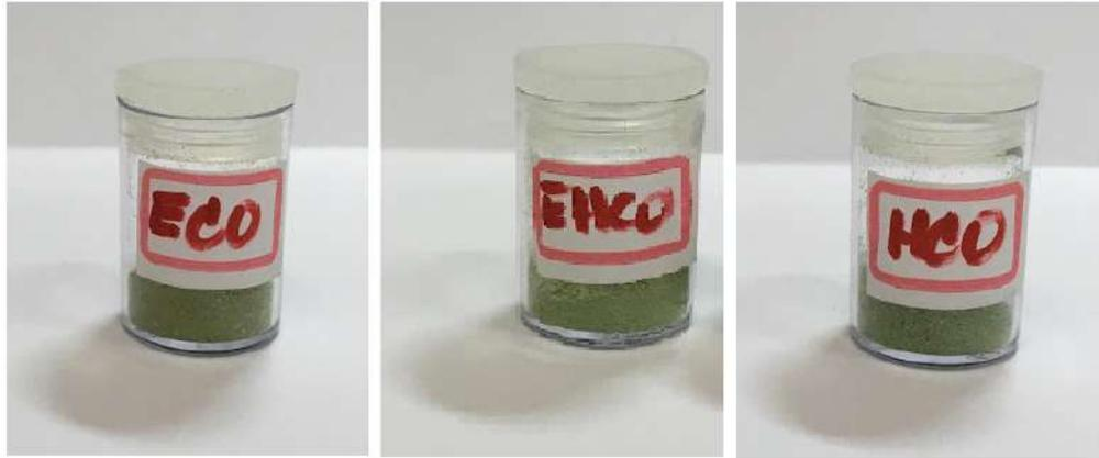
Figura 20 – Amostras em pó obtida após tratamento térmico no forno circular a 1373 K durante 24h, sendo que na figura estão rotuladas como ECO ( $x=0.0$ ), Cromita de Európio, EHCO ( $x=0.5$ ), Cromita de Európio dopada com Hólmio 50/50 e HCO ( $x=1.0$ ), Cromita de Hólmio.
