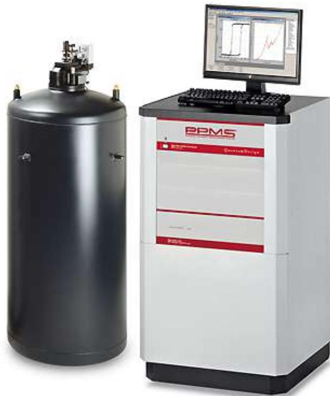
Figura 17 – Sistema de Medidas de Propriedades Físicas (PPMS), figura modificada da literatura ( Quantum Desing, 2004).
