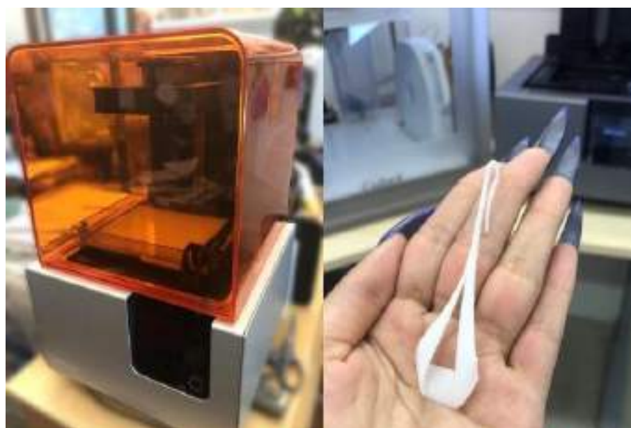
Figura 25 - Impressora Form2 e protótipo impresso em resina.
