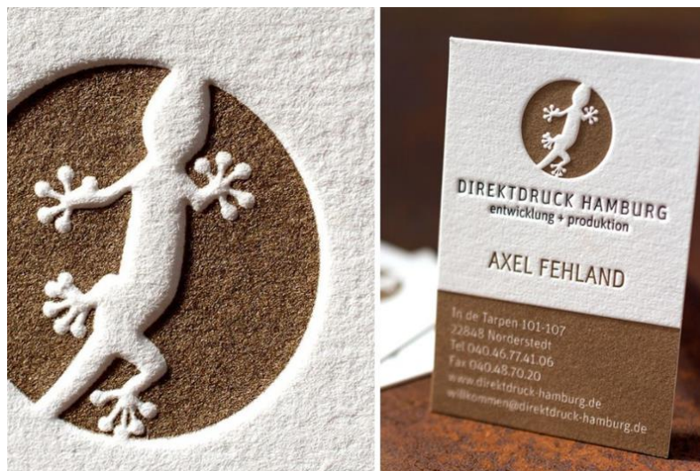
Figura 39: Aplicação de relevo texturizado localizado pelo Letterpress /Relevo seco.
