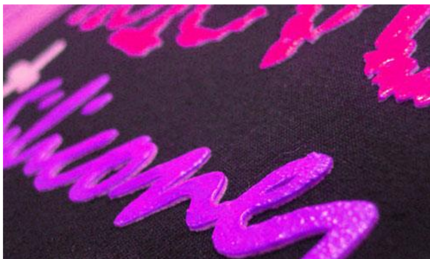
Figura 40: Aplicação de relevo texturizado localizado pela Serigrafia
