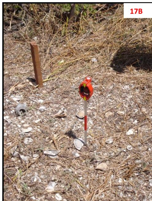
Figura 17: Foto 17A: Estação total Leica, modelo TC407 sobre o marco SB-01 e prisma com alvo de pontaria incorporado e Offset 0mm e 30mm; Foto 17B: Mini-prisma de pontaria incorporada e Offset 0mm e 17mm sobre a área de estudo.
