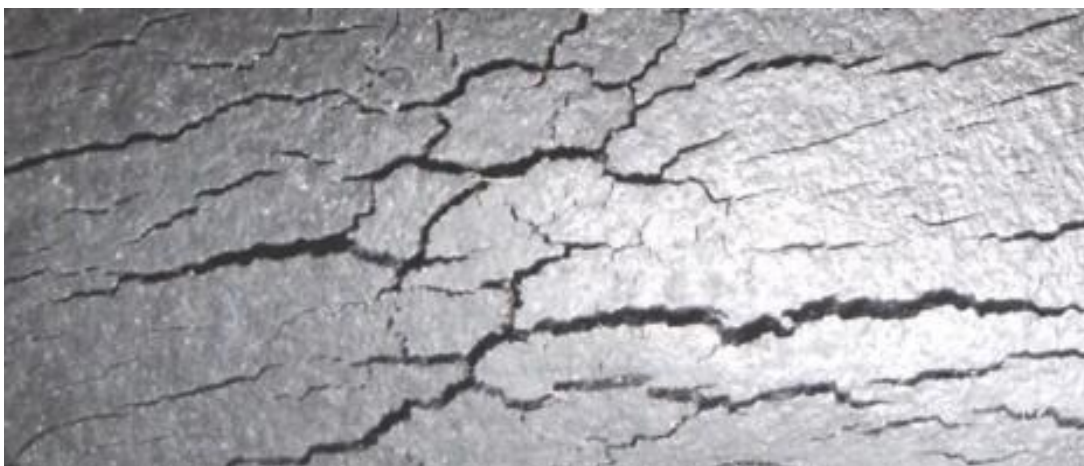
Figura 5 - Ozonólise. A Borracha Degradada por Ação do Ozônio.
