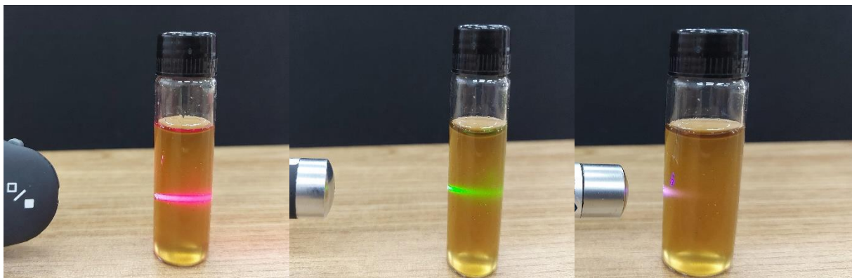
Figura 20- Testes para verificação do Efeito Tyndall na suspensão de Óxido de Grafeno.
