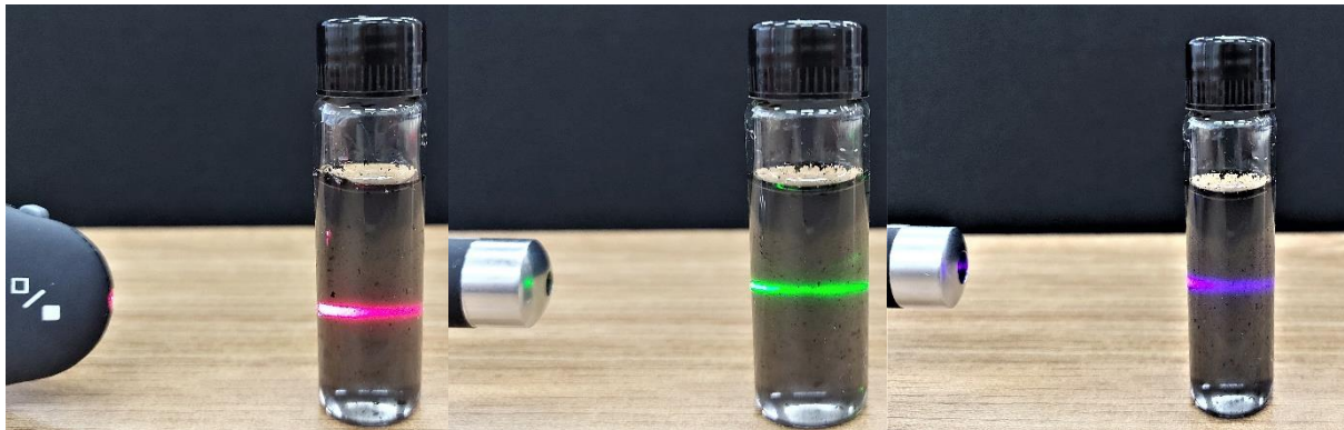
Figura 24- Testes para verificação do Efeito Tyndall na suspensão de Óxido de Grafeno reduzido.
