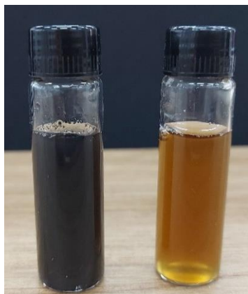
Figura 21 – Óxido de Grafeno reduzido a esquerda e Óxido de Grafeno a direita.
