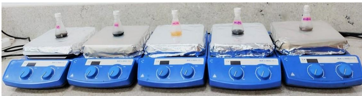
Figura 43 – Experimento inicial de adsorção. Da esquerda para a direita: GO, rGO, MIL-100 (Fe), MIL-100 (Fe)@GO e MIL-100 (Fe)@rGO.
